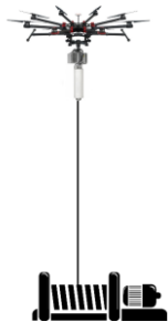
Hình 5. Cấu trúc của hệ thống tUAV
