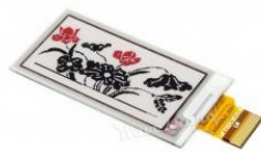
Hình 6: Màn hình E-ink kích thước 104*212
