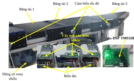
Hình 4. Hệ thống băng tải được dùng để thực nghiệm.
