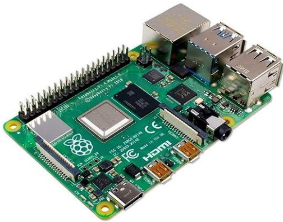
Hình 2. Máy tính nhúng Raspberry Pi 4
