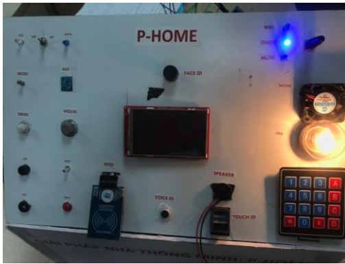
Hình 11: Mô tả tính năng điều khiển thiết bị qua giọng nói trên IoT node
