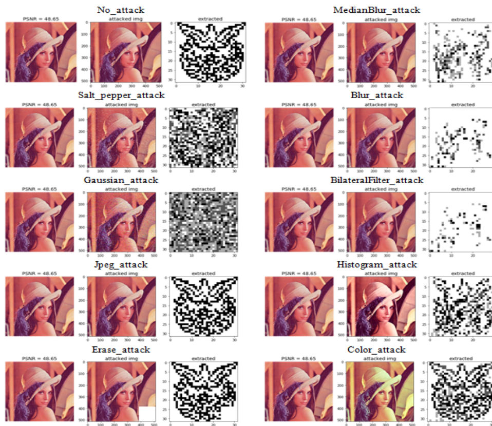
Hình 5: Kết quả sau khi nhúng thông tin thủy vân (DWT1D-DCT)
